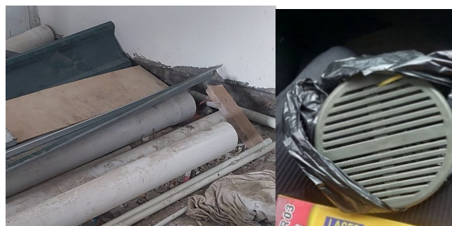
Gambar 3 Pipa 4" dan Penutup Biopori (sumber: Dokumentasi Penulis)
