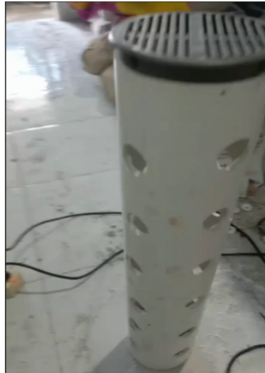
Gambar 6 Pipa yang sudah dilubangi (sumber: Dokumentasi Penulis)
