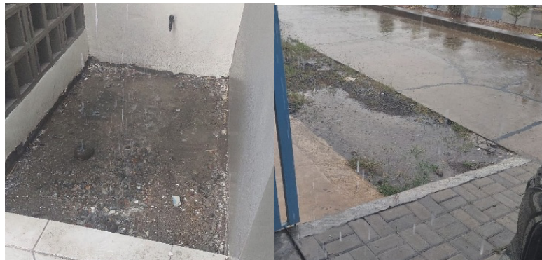
Gambar 9 Perbedaan Resapan Air dengan Biopori (Kiri) dan tanpa biopori (Kanan) (sumber: Dokumentasi Penulis)
